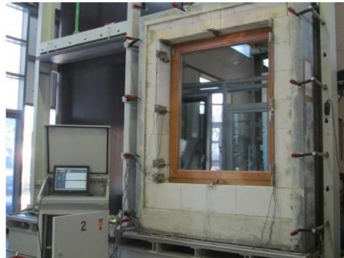
Bild 7 Ansicht Probekörper mit angebrachten Messstellen
