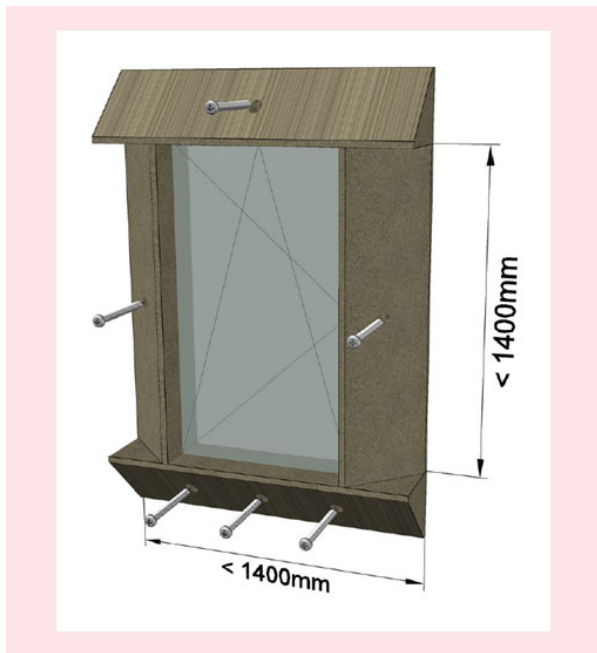
illbruck MOWO - mocowanie profili instalacyjnych na przykładzie profilu PR007
